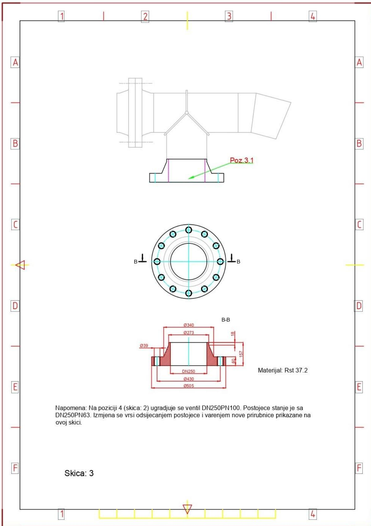
Napomena: Na poziciji 4 (skica: 2) ugradjuje se ventil DN250PN100. Postojeće stanje je sa DN250PN63. Izmjena se vrši odsjecanjem postojeće i varenjem nove prirubnice prikazane na ovoj skici.
